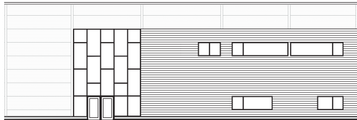
Fasadutsnitt - Sporthall med prefabfasader i mörkgrått kominerad med faluröd träpanel
